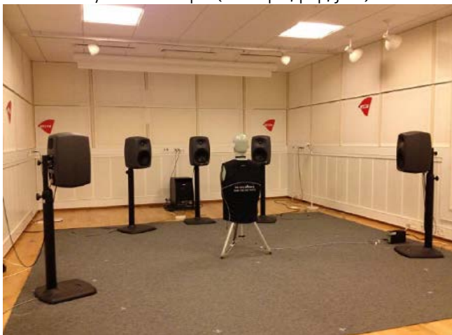
Figure 2. La configuration dans la salle d'écoute standardisée EBU 3276 de DELTA pour les enregistrements de l'aide auditive.
